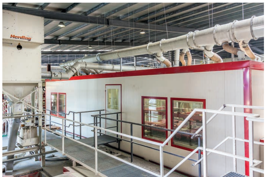
Herding Flex jako centralny system filtrowania w zakładzie firmy Godelmann.
